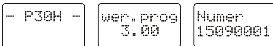
Rys.5. Komunikaty startowe przetwornika nie wyposażonego w interfejs Ethernet
